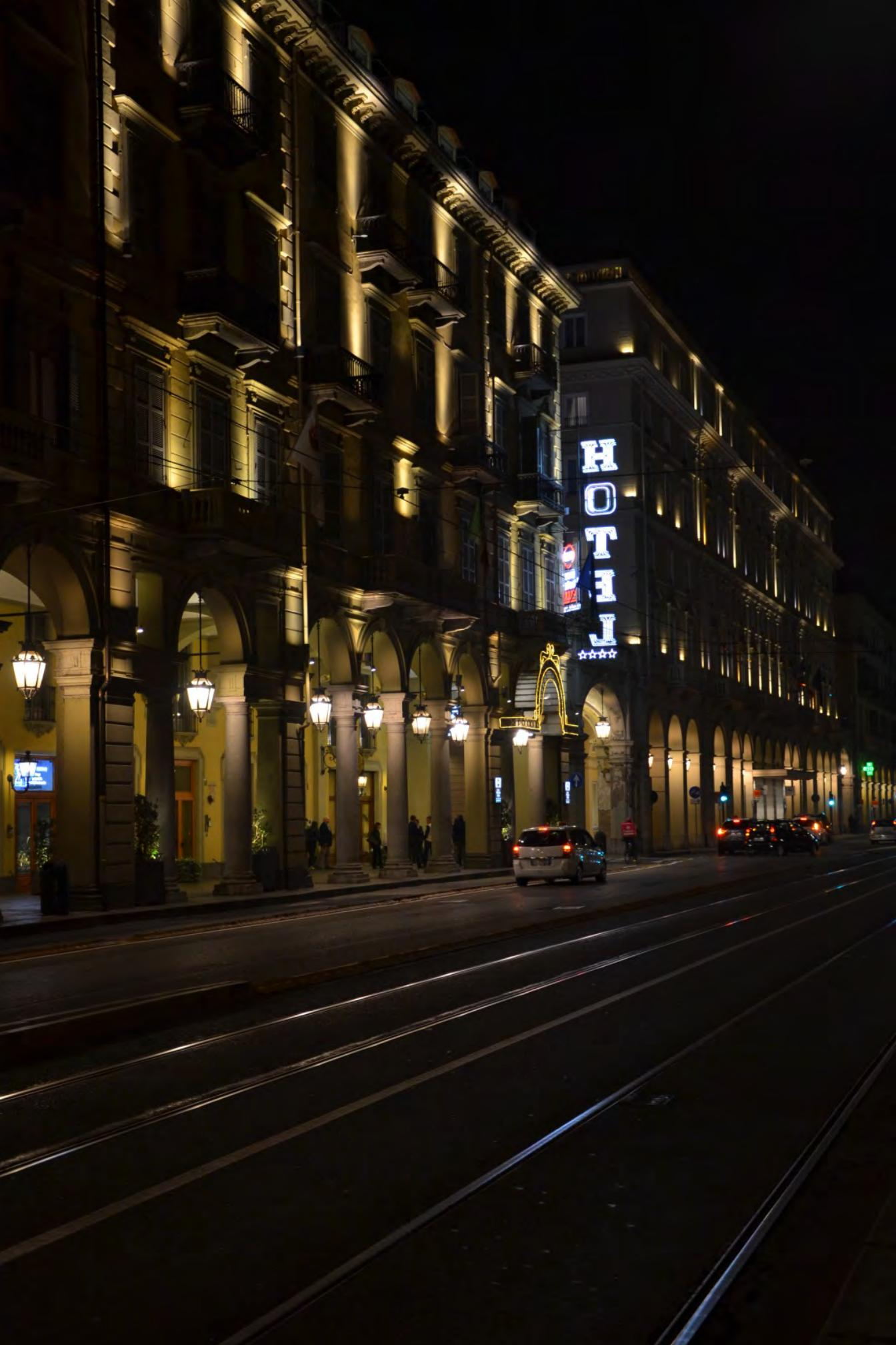
Nel tratto tra i corsi Sommeiller e Stati Uniti (in basso) una semplice sorgente ai **vapori di sodio** bassa pressione (luce arancio) contrappunta nel ritmo la sobria illuminazione **su palo, a luce bianca**, sul lato est. In assenza di un piano della luce di dettaglio, solo gli alberghi propongono una **illuminazione di accento a LED**, ma a fascio stretto, poco coordinata alla partitura ritmica di facciata. Lo si nota sulla facciata degli Hotel Genova e Turin.
